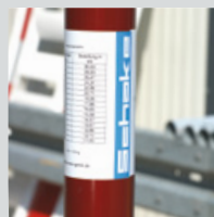
Tous les étais sont identifiés avec classe de type et tableau de charge.
