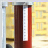
La hauteur de manchon de réglage peut être repérée de manière optimale grâce à une échelle graduée.
