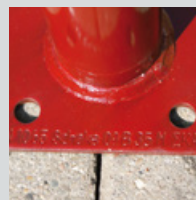
Tous les étais sont identifiés avec classe de type et tableau de charge.
